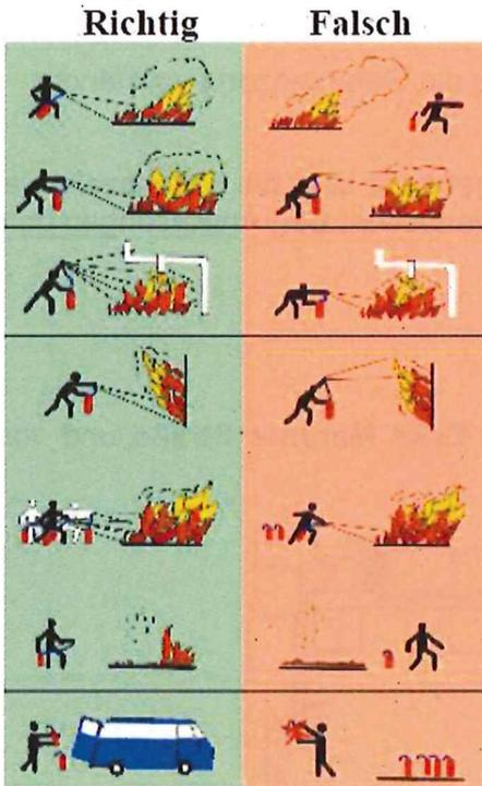
**B 10.4** Den Strahl des Feuerlöschers über die Oberfläche einer brennenden Flüssigkeit richten, nicht direkt auf oder in die Flüssigkeit: Der Druckstoß kann zu einer weitflächigen Verteilung und damit Ausbreitung des Brandes führen.
